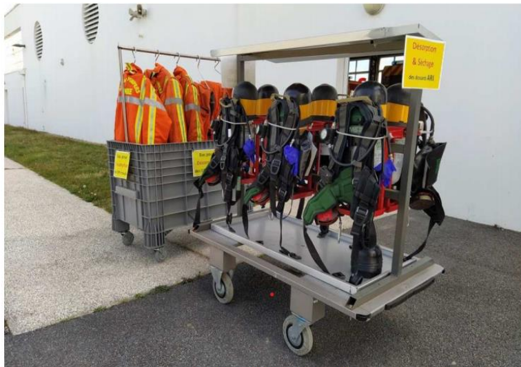
Exemple de portant permettant la désorption des équipements à l'air libre © Maxime Fonteneau - SDIS 85
