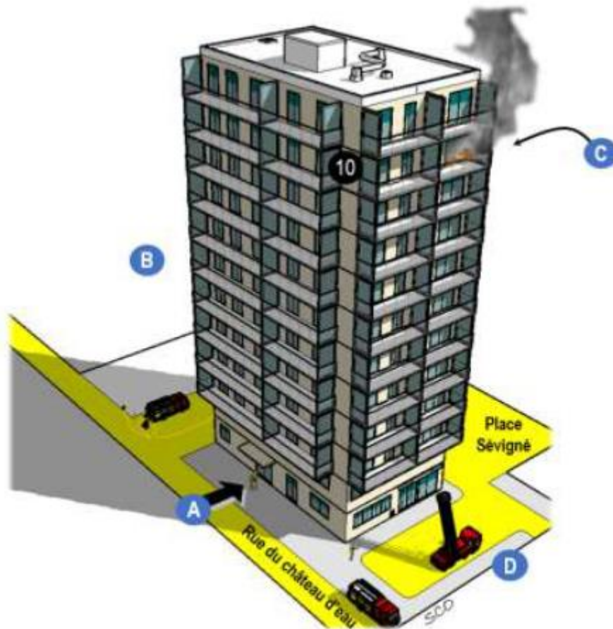
Schéma n°13 : Principe d'appellation des façades
